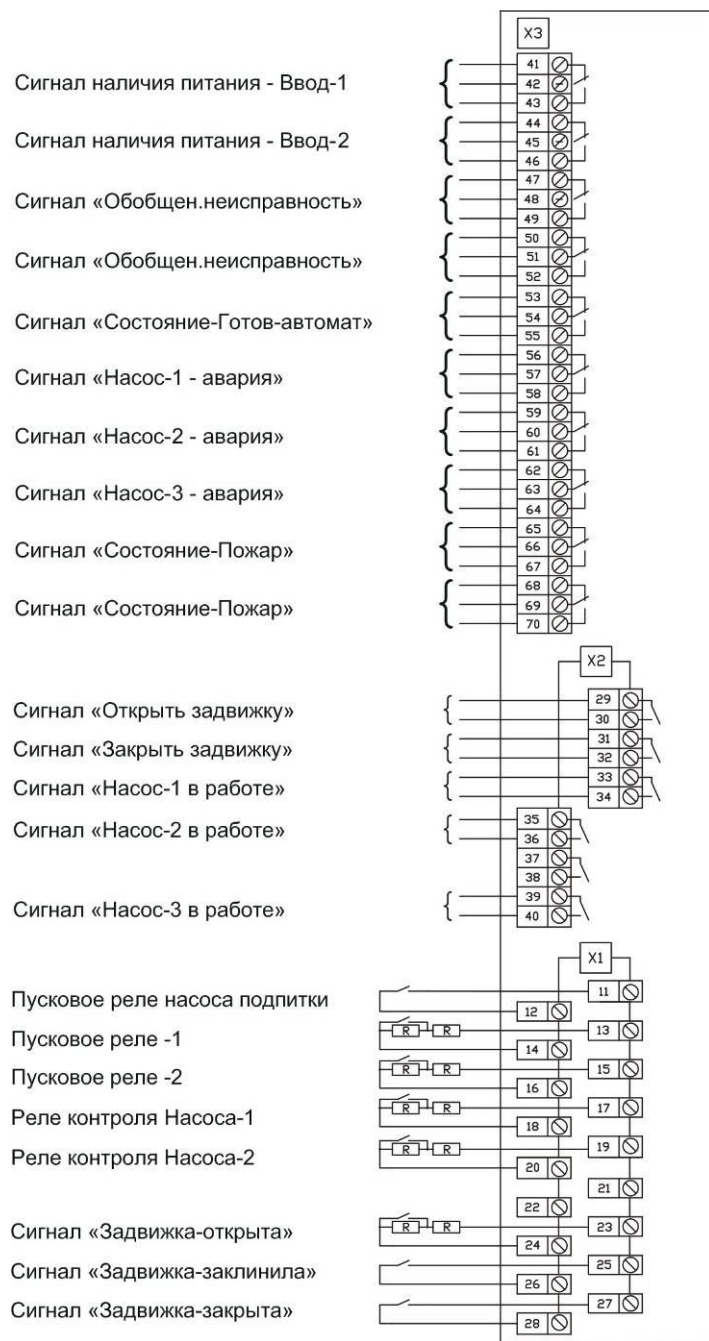
Рис.4 Схема подключения сигнальных цепей (X1, X2, X3)
